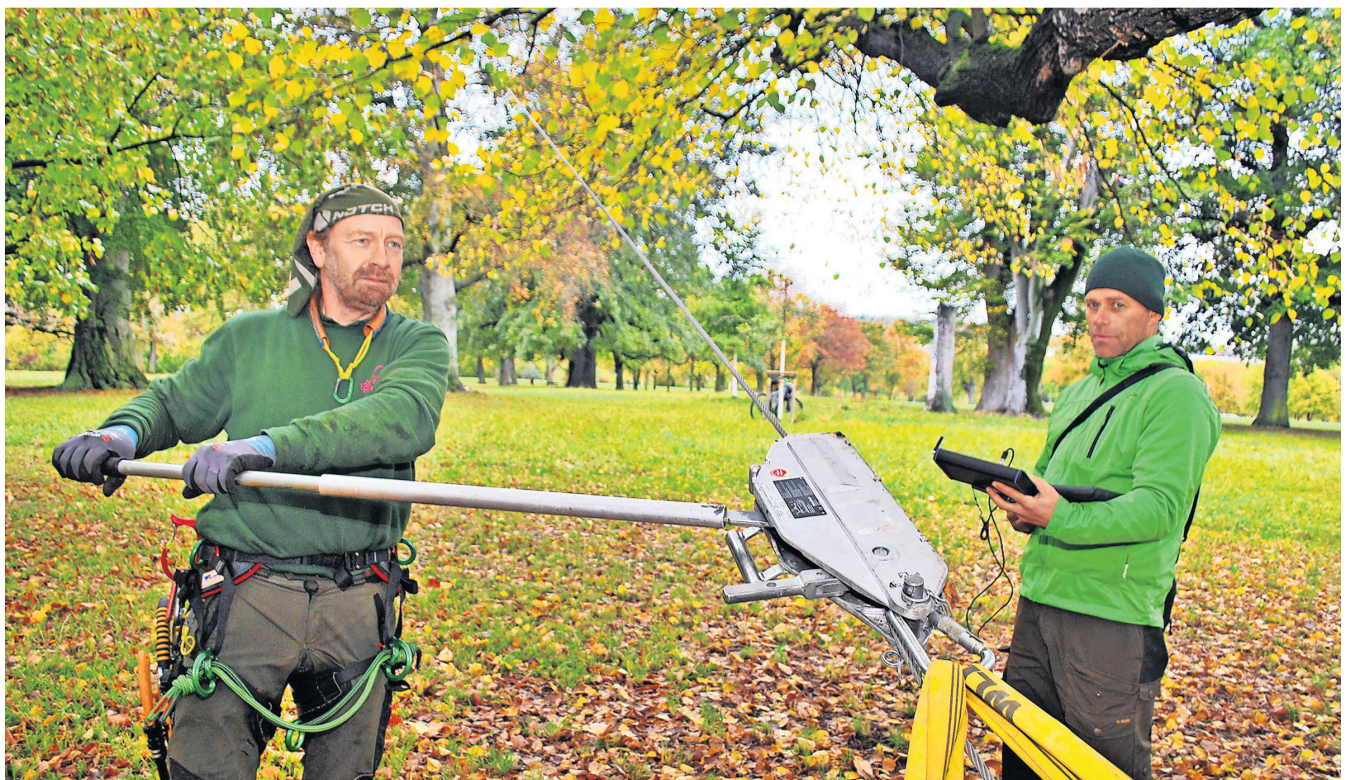
James Holmes (links) und Oliver Gaiser beim Zugversuch im Rosensteinpark
